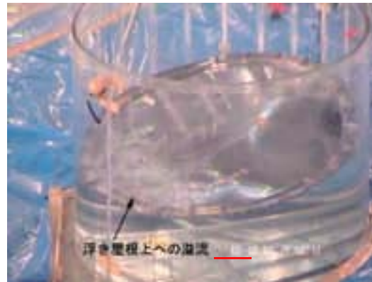
図4 模型実験における内部浮き蓋上への液体の乗り上げ状況
